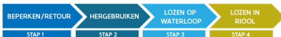
Figuur 7-31: de opeenvolgende stappen van de bemalingscascade (bron: VMM)
