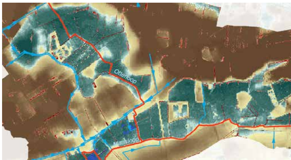
Figuur 7-14 Illustratie van landschapsdepressies in het stroomgebied van de Otterloop en de Maasloop (groene zones) die worden gedraineerd via (publieke) grachten (blauwe lijnen en pijlen, oranje stippellijnen en de lijnvormige clusters van rode pixels) die verbonden zijn met waterlopen
